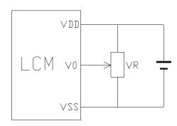
$V_{\text{DD}\sim}V_0$ : LCD Driving voltage
